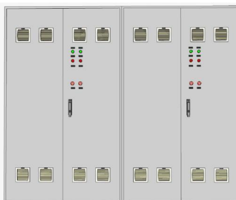
Figura 11 - Led sinalizador e Botão de emergência - Quadro dos Inversores
